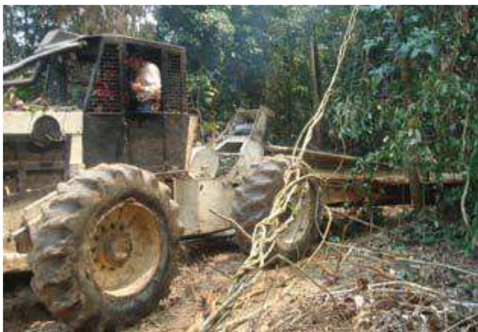
Figura 17-12. Procedimento de arraste mecanizado de árvores para as áreas de traçamento.
