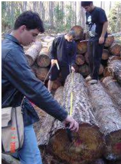
Figura 17-19. Medição do comprimento da tora ou torete com fita métrica.
