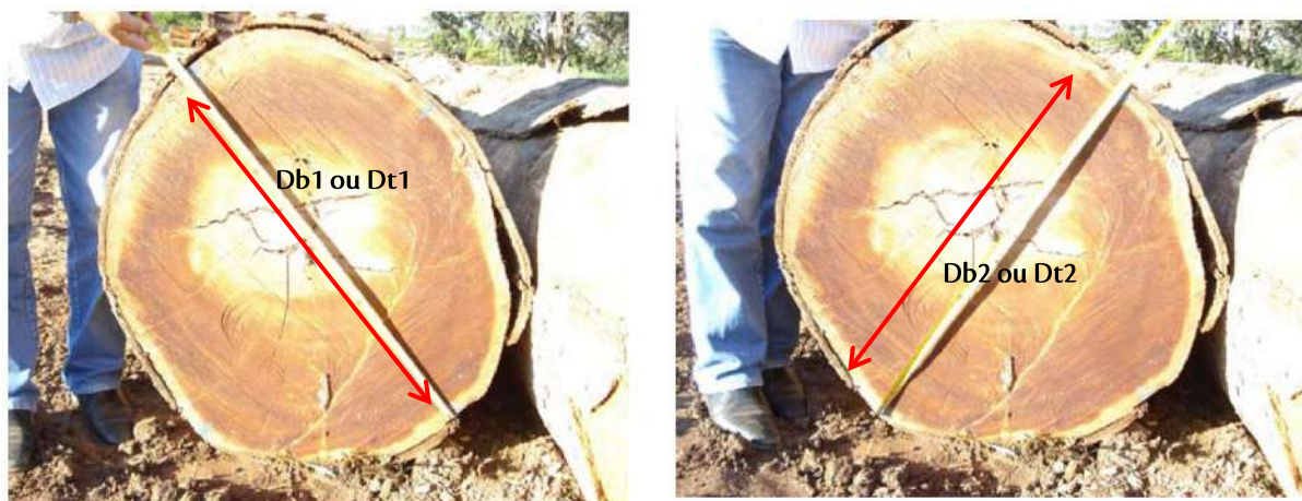
Figura 17-13. Medição dos diâmetros da base e topo da tora através da medição em cruz. Fonte: SBS (2012).
